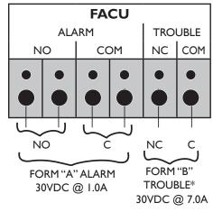
\*TROUBLE CONTACTS ARE SHOWN IN ENERGIZED CONDITION. UNDER NORMAL OPERATION CONTACTS WILL BE HELD AS SHOWN.
